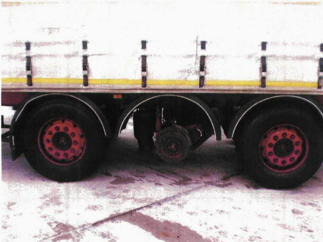
Dieser Sattelanhänger wurde mit einem fehlenden Hinterrad angehalten.
