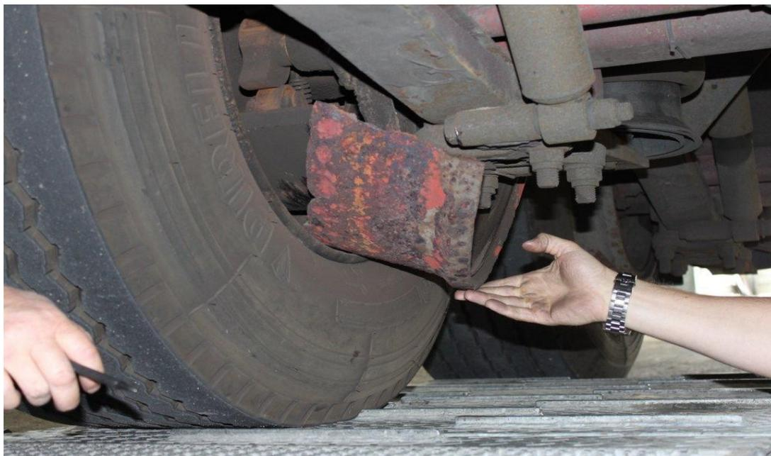
Dieses Fahrzeug wurde mit einer gebrochenen und teilweise abgelösten Bremstrommel angehalten.
