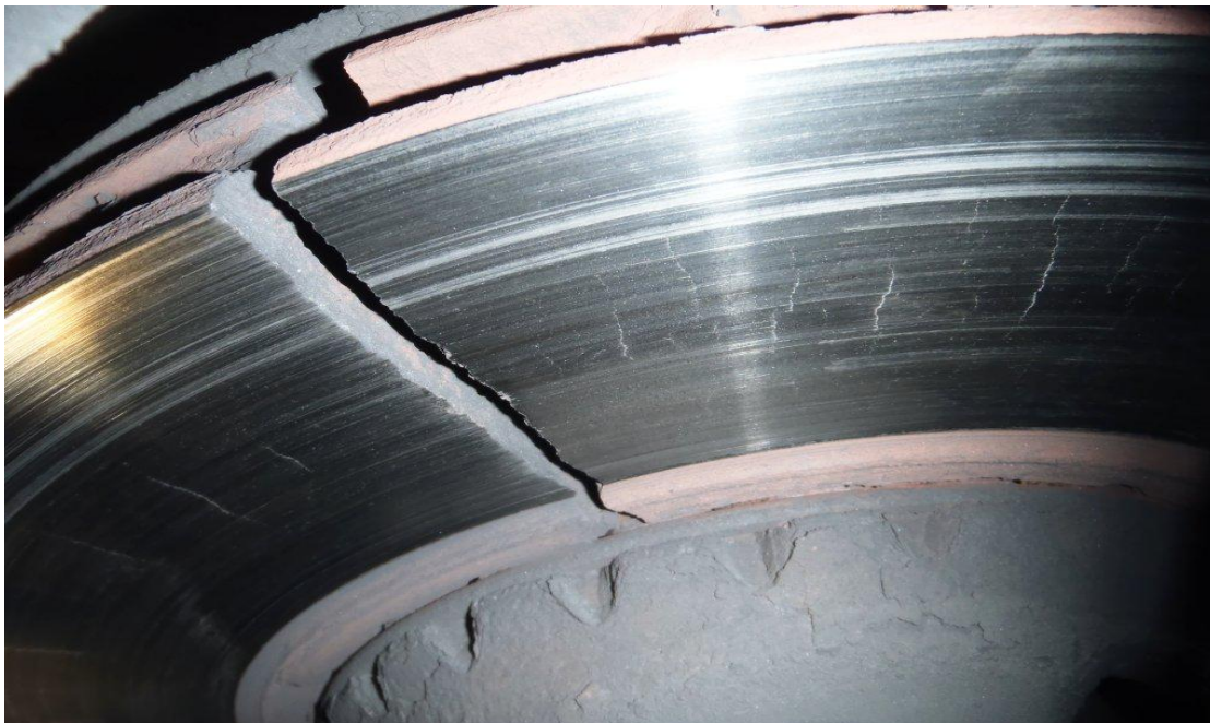
Gefahr im Verzug: gebrochene Bremsscheibe
