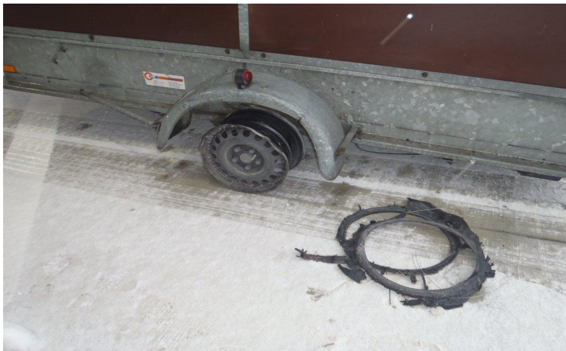
Gefahr im Verzug: abgelöster Reifen
