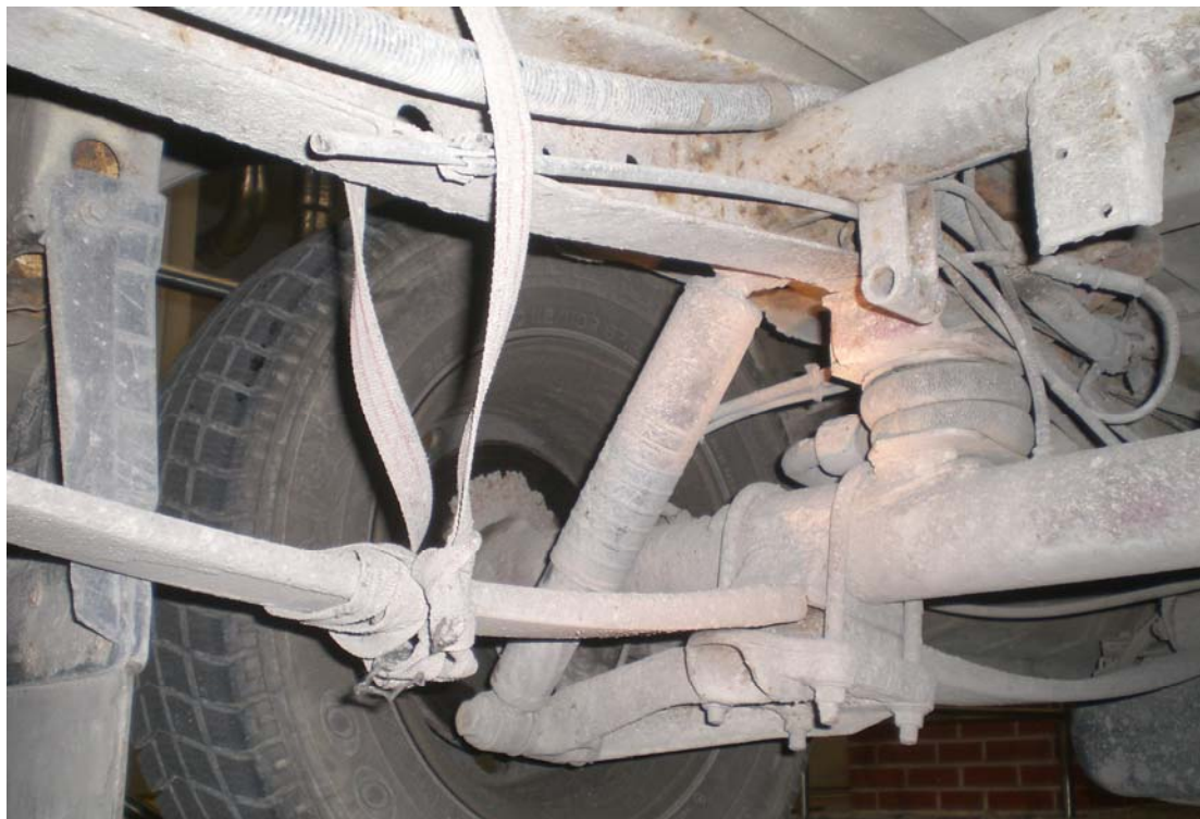
Gefahr im Verzug: gebrochenes Federblatt
