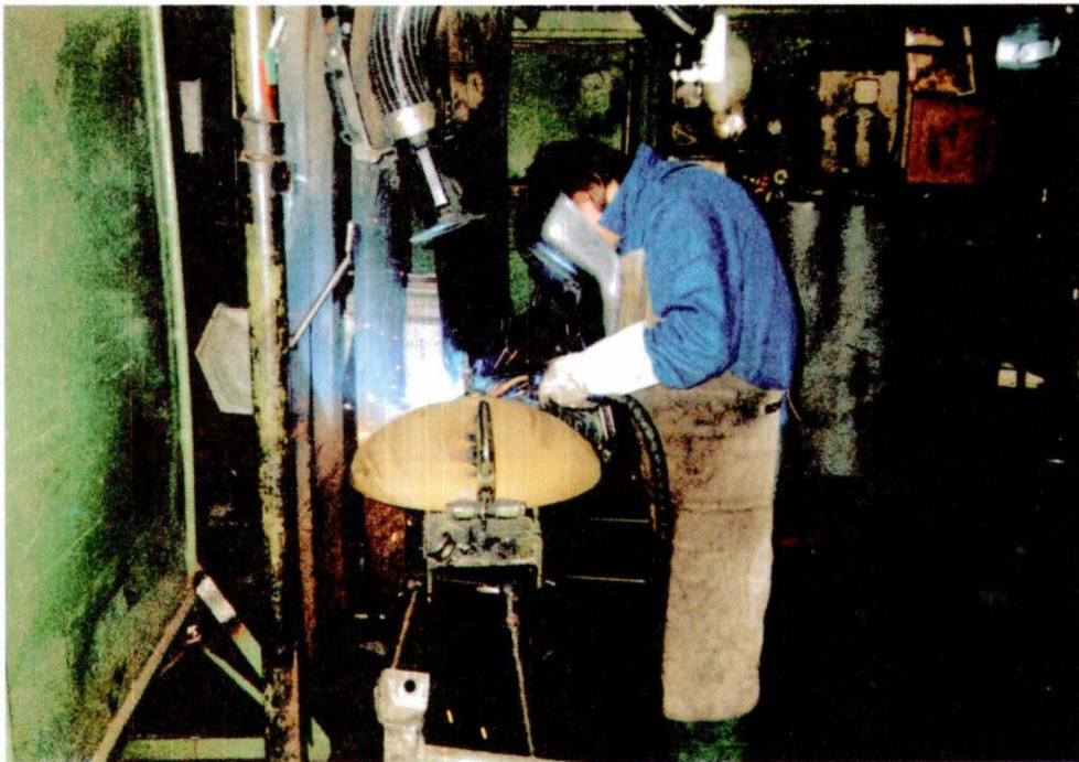
Bild 2: Handschweißplatz mit Rüsselsaugstutzen
