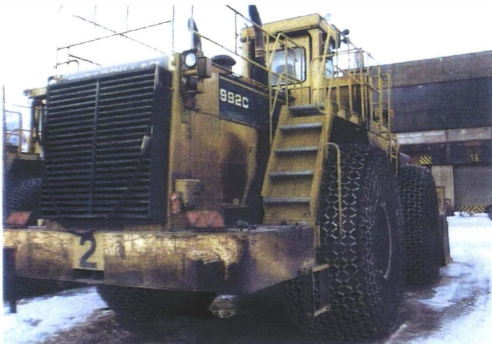
Radlader mit sichererem Aufstieg
