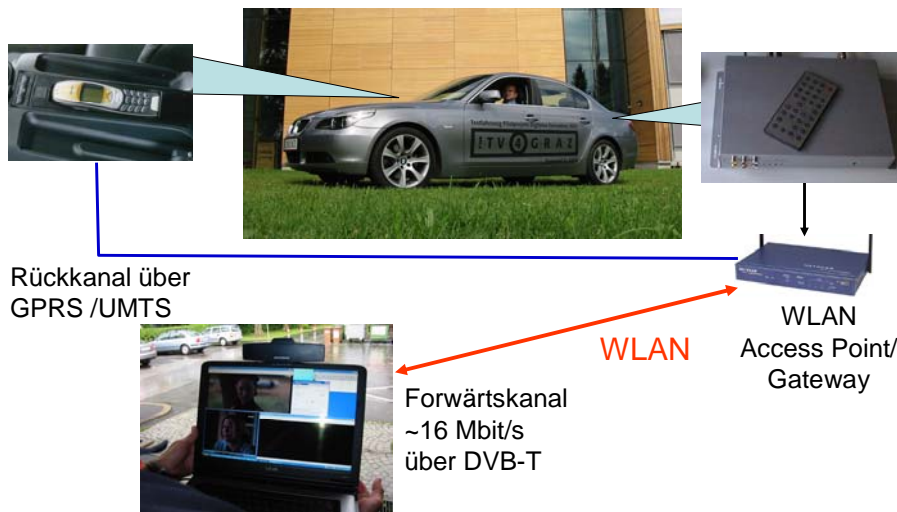
Abbildung 38: DVB-T Infrastruktur im Testfahrzeug
