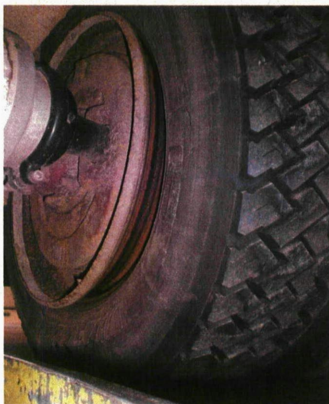
Luftleerer Reifen, der sich bereits von der Felge ablöste.
