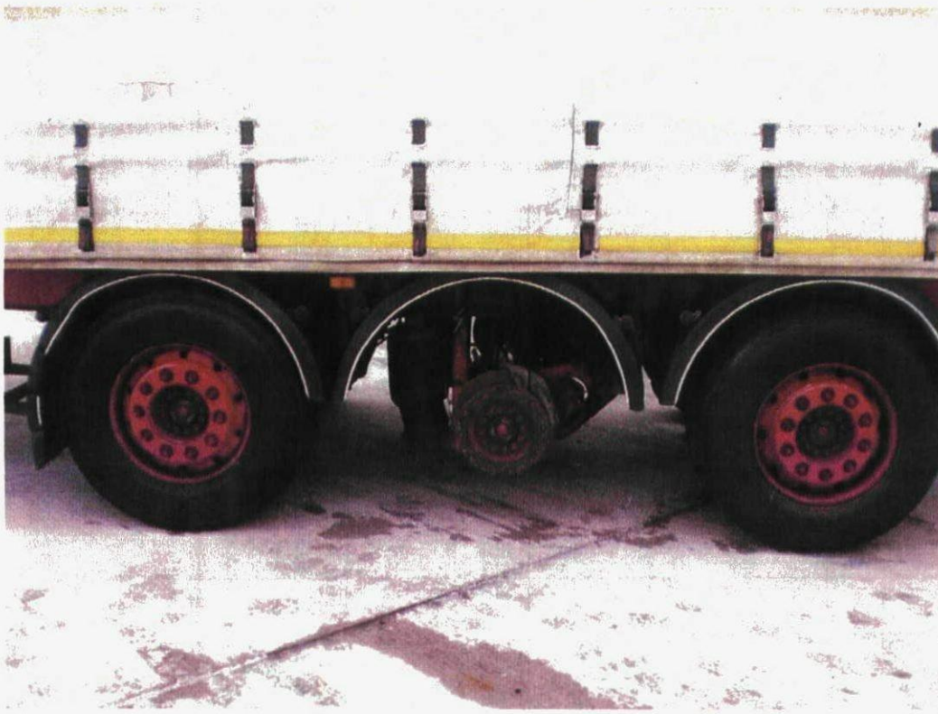
Dieser Sattelanhänger wurde mit einem fehlenden Hinterrad angehalten.
