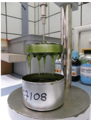
Der Vorversuch zeigt das Abrinnen der Probe an einem Löffel (ergibt erste Hinweise, ob das Kriterium „flüssig“ oder „fest“ zutrifft). Das rechte Bild zeigt die Messapparatur nach Beendigung des Versuches.
