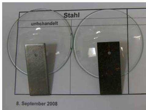
Prüfung auf ätzende Eigenschaften: links ein un behandelter Prüfkörper (als Vergleich), rechts der behandelte Prüfkörper.
