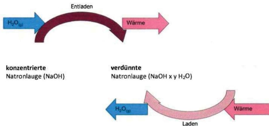
Abbildung 5: Funktionsprinzip der Wärmespeicherung mittels Natronlauge
