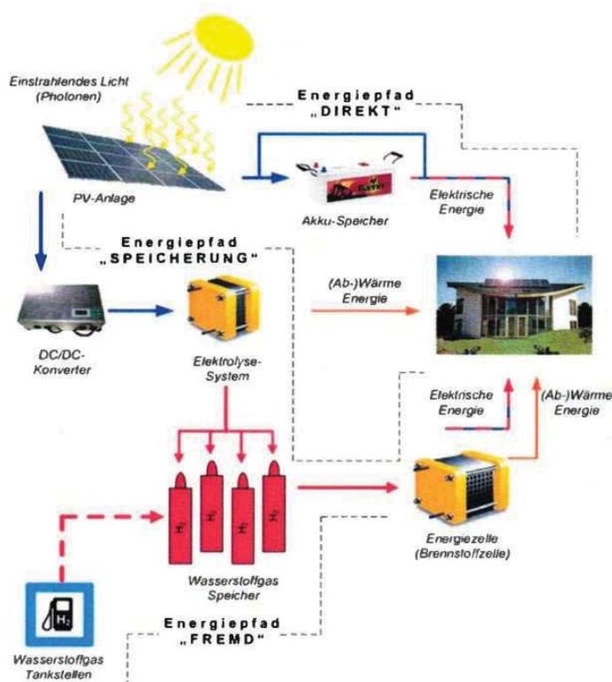
Abbildung 3: Konzept einer autarken Energieversorgung <sup>[1]</sup>
