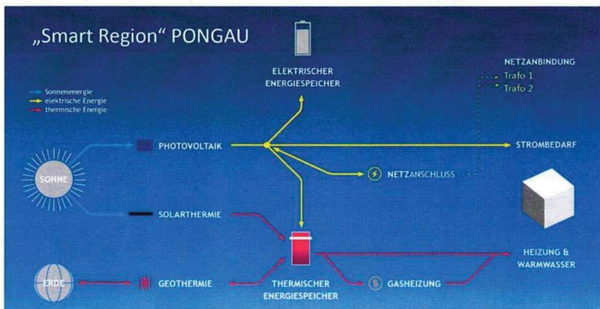
Abbildung 1: Konzeption eines intelligenten Netzes für nachfrageorientiertes Management im Salzburger Pongau
